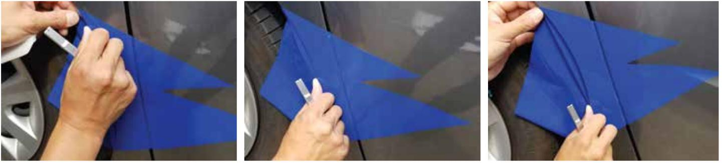
タイヤハウスの部分は上から指で押し、曲線の型を付けます。
