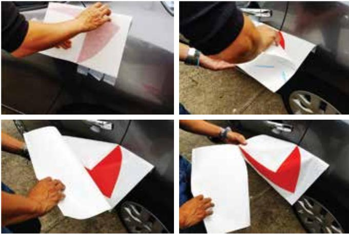
固定した位置がずれないように折り返して裏紙(厚い方の紙)を剥がしてください。
