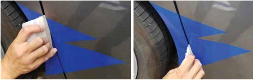
切り終わった断面に隙間にスキージーを差し込み、こすりながら圧着させます。
